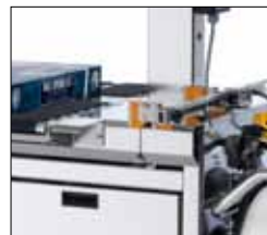
Pakethöhe Die Umreifung wird unterdrückt, wenn die eingestellte Höhe über- oder unterschritten wird.
