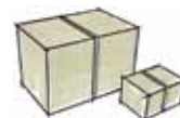
Paketmitte Die Pakete werden – unabhängig von ihrer Länge – automatisch in der Paketmitte umreifert.
