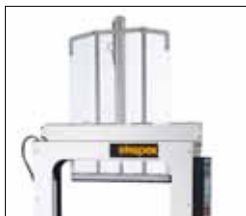
Niederhalter Pneumatischer Niederhalter, zum Festhalten von leichten Paketen während dem Umreifungsvorgang. Kann auf Maschineneinlauf- und/oder Maschinenauslaufseite montiert werden. Druckluftbedarf (5 bar)
